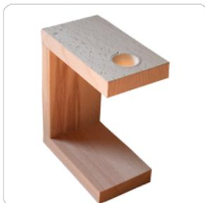
Die Sondenhalterung unterstützt eine einfache Durchführung der Magnetfeldmessung an Brillen. Dabei wird die Messsonde fixiert und das Brillengestell kann an selbiger entlanggeführt werden.
